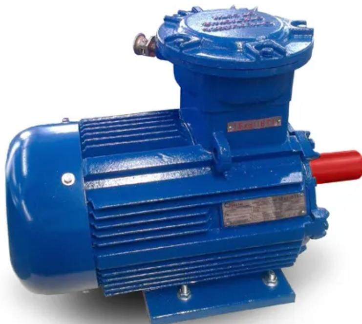
Предназначен для работы в режиме S1 от сети переменного тока 50Гц, напряжением 380V (220/380V, 660V). Стандартная степень защиты - IP54 (IP55), исполнение по взрывозащите 1ExdIIBT4 (1ExdeIIBT4), климатическое исполнение и категория размещения - У2 (У 2,5, У1)
