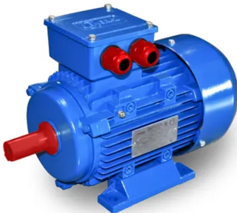
Электродвигатель общепромышленного назначения предназначен для работы в режиме S1 от сети переменного тока 50Гц, напряжением 380V (220, 660V). Стандартная степень защиты - IP54 (IP55), климатическое исполнение и категория размещения - У3 (У2, У1)
